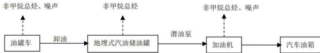
图 2.3-2 项目柴油卸油及加油工艺流程图
